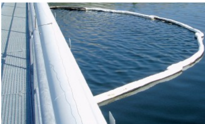
Metalli renkaat helpottavat yhteen liittämistä Useammat puomit muodostavat padon rajaamaan vuotoa
